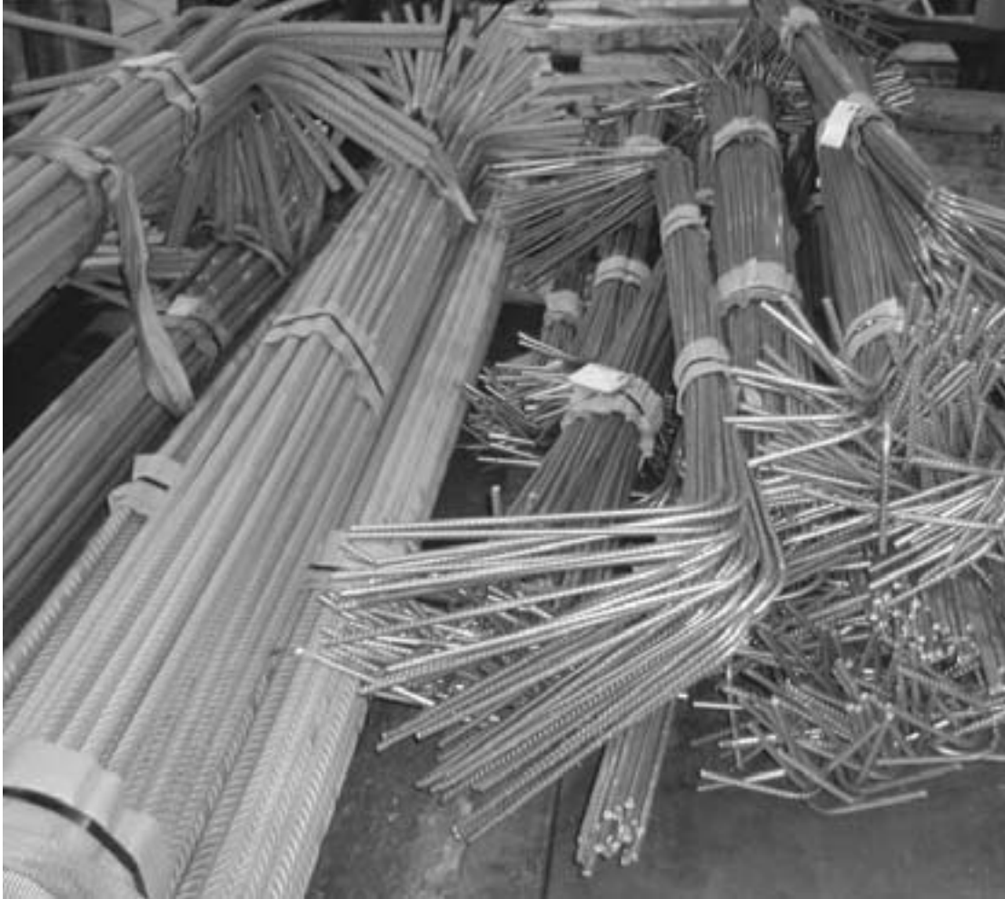
Armatures inox prêtes à être livrées.
