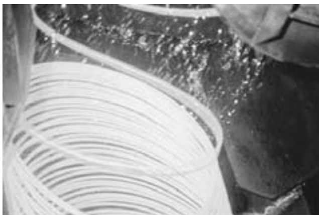
Laminage à chaud du fil machine.
