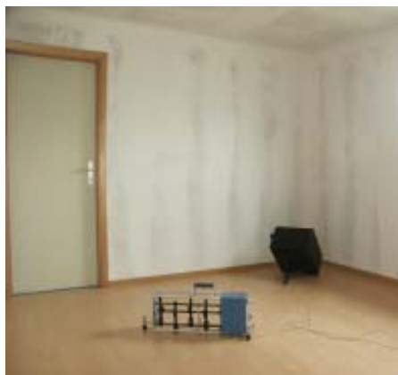
Fig. 7 La présence d'une porte de faible isolation dans un cloisonnement diminue l'isolement de l'ensemble.
