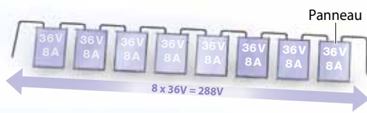
Fig. 4 : Exemple de chaîne photovoltaïque impliquant 8 modules.
