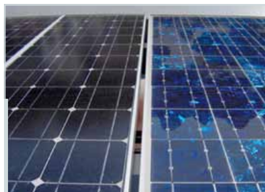
Panneaux au silicium monocristallin (à gauche) et au silicium polycristallin (à droite)
