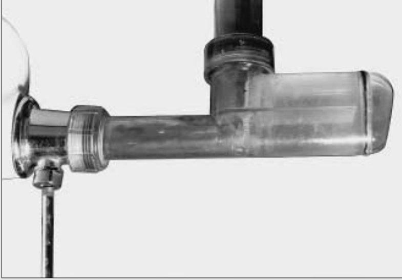
Siphon de lavabo: l'eau contenue dans le siphon empêche les remontées de mauvaises odeurs
