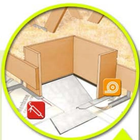
Raccordement à une trappe
