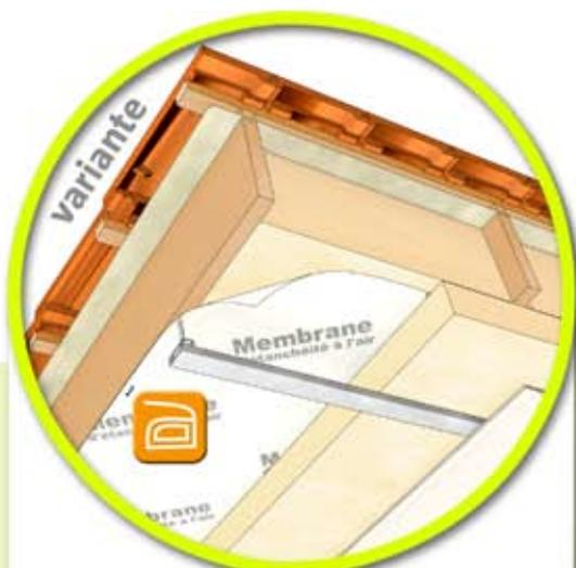
**Membrane entre les deux couches d'isolants**
