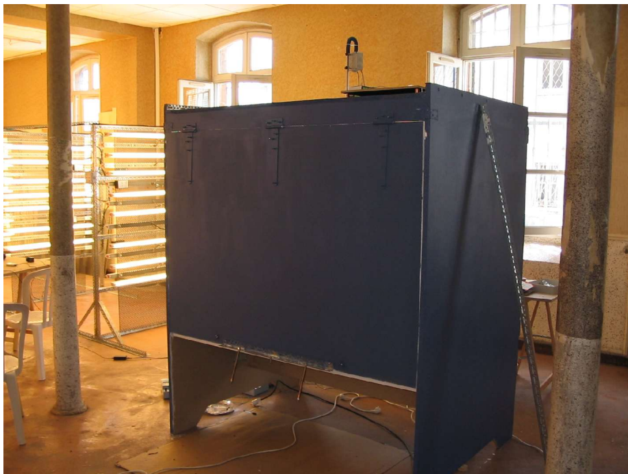
Figure III-4 : Perspectives du cube intégrateur
