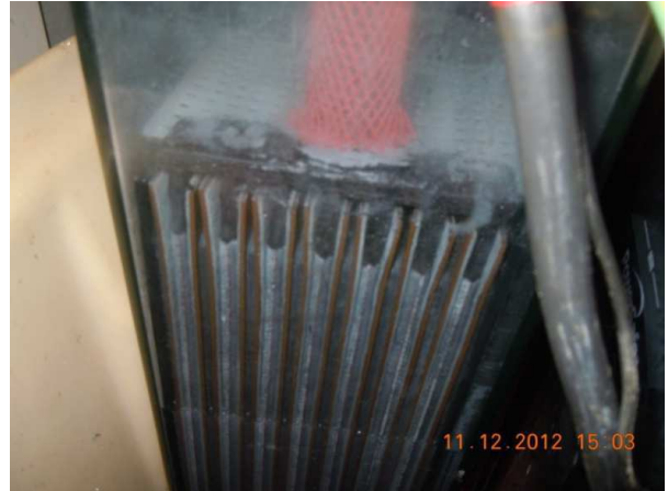
Figure 5 Photographie d'une batterie acide-plomb constituée de plusieurs électrodes baignant dans l'électrolyte
